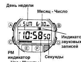
На рис.1., изображен общий вид часов в режиме Текущего времени. Кнопка С осуществляет переход между режимами часов. После осуществления необходимых действий в любом режиме, нажмите кнопку С для возврата в режим текущего времени. Переход между режимами осуществляется в следующей последовательности:
