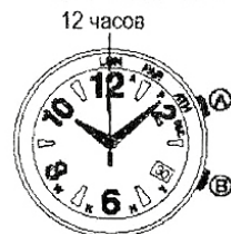
Корректировка основной позиции секундной стрелки
