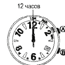
Корректировка основной позиции часовой и минутной стрелки
