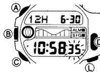
3. В то время, когда цифры в разряде секунд будут находиться в мигающем состоянии, нажмите кнопку “D”, для сброса счетчика секунд в “00”. Если кнопка “D” нажата в то время, когда значение секунд будет находиться в диапазоне от “30” до “59”, то одновременно с переустановкой секунд в положение “00”, к значению минут будет добавлена “1”. Если значение секунд в этот момент будет находиться в диапазоне от “00” до “29”, то значение минут останется без изменений.
