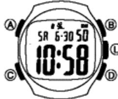
На рисунке изображен общий вид часов в режиме текущего времени. Нажмите кнопку "C" для перехода из режима в режим.
