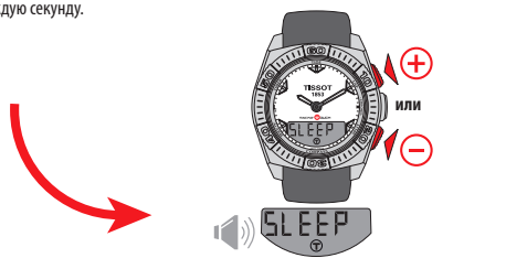
б) + / - : остановка отсчета, часы не переходят в режим ожидания
