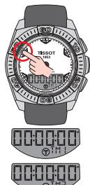
Индикация первого таймера. Нажмите дважды, чтобы перейти ко второму таймеру.
