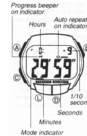
Обратный отсчет времени может быть задан в диапазоне от 1 секунды до 24 часов. Как только счетчик обратного отсчета достигнет нуля, раздастся звуковой сигнал продолжительностью 10 секунд, который может быть отключен нажатием любой кнопки.
