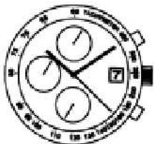
Тахометр – это устройство, измеряющее скорость автомобиля. Зная, за сколько секунд машина проезжает 1 км, можно определить приблизительную среднюю скорость в час во время путешествия. Если хронограф запустили в некоторое время, и остановили через 1 км, средняя часовая скорость может быть измерена по положению секундной стрелки. Если машина преодолевает расстояние в 1 км за 45сек., то средняя часовая скорость будет около 80 км/ч.
