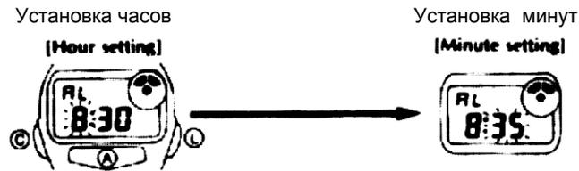
Нажмите кнопку "L" в Режиме Будильника для установки значения часа. Каждое нажатие кнопки "А" увеличивает значение часа на 1.
