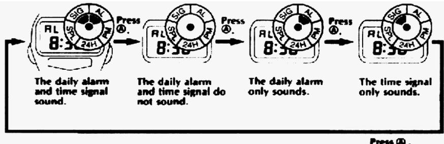
Включены ежедневный будильник и ежечасный сигнал      Оба сигнала отключены      Включен только ежедневный будильник      Включен только ежечасный сигнал
