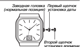
Заводная головка (нормальная позиция) Первый щелчок установка даты Второй щелчок установка времени
