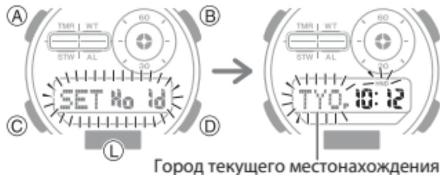
режим настройки. Стрелки автоматически сместятся в сторону от цифрового экрана.
