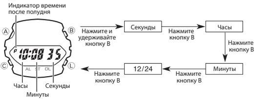
1. В режиме Текущего времени нажмите и удерживайте кнопку В около 2 секунд, пока на цифровом экране не отобразится индикатор ADJ. Как только индикатор ADJ исчезнет, на цифровом экране начнут мигать цифры секунд. После этого можно отпустить кнопку В.
