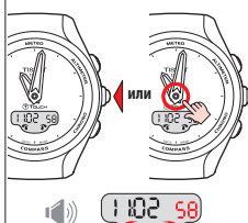
Подтверждение настройки минут и вход в режим синхронизации секунд (T1) .
