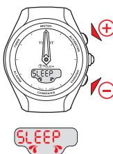
б) \oplus / \ominus : остановка отсчета, часы не переходят в режим ожидания.
