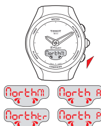
Выбор местного климата: T = умеренный; M = средиземноморский; A = сухой; tr = тропический; P = полярный
