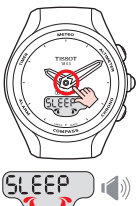
Автоматический переход в режим ожидания через 10 секунд Звуковой сигнал на каждой секунде (см. с. 9)
